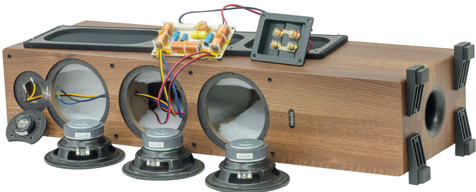
Il diffusore con tutti gli elementi in bella vista. Notiamo la flangia del tweeter modellata per avere il centro acustico il più vicino possibile a quello del midrange, lo stampato del filtro crossover con le induttanze avvolte su nucleo di lamierini tranne quella del tweeter che è avvolta in aria, la vaschetta dei contatti, il midrange ed i due woofer.
