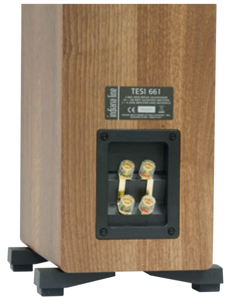
Il diffusore visto da dietro. Alla base è sistemata la vaschetta per i connettori, ma non vediamo alcun condotto di accordo. La vaschetta portacontatti è quella classica, con il corpo in plastica ed i quattro morsetti dorati per bi-wiring.
